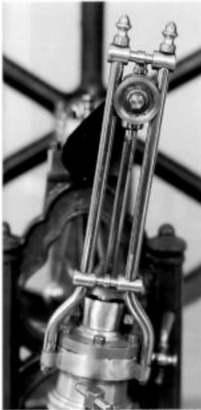
oben: Für die Befestigung der Geradföhrung für die Kolbenstange wurden Augen aus dem Zylinderflansch ausgearbeitet.
