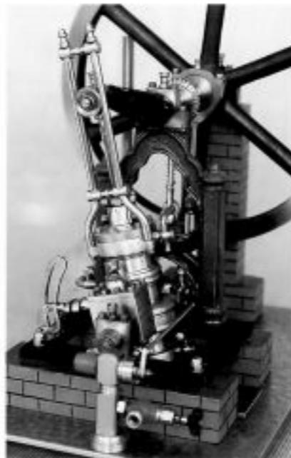
oben: Die Stellung des schwingenden Zylinders zeigt die gleichzeitig veränderte Stellung der Pleuelstange, die durch die feststehende Kurbel betätigt wird.
